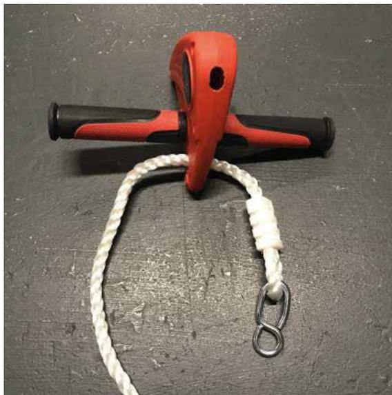
Étape 5b: Tirez la corde jusqu'à l'autre extrémité de la double boucle métallique à travers du trou du chariot à main.
